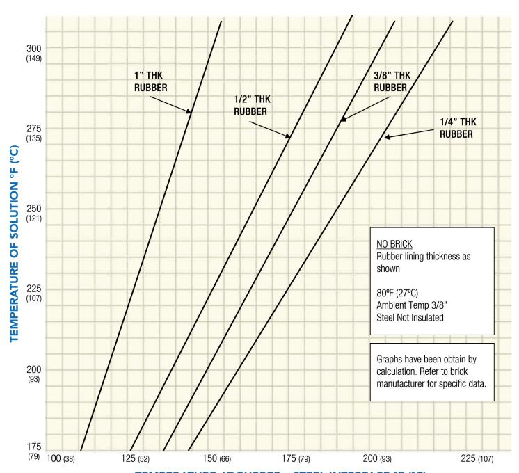
TEMPERATURE AT RUBBER – STEEL INTERFACE °F (°C)
